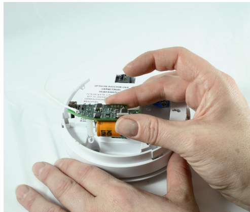
Einsetzen eines Funkmoduls ist auch nachträglich noch möglich
